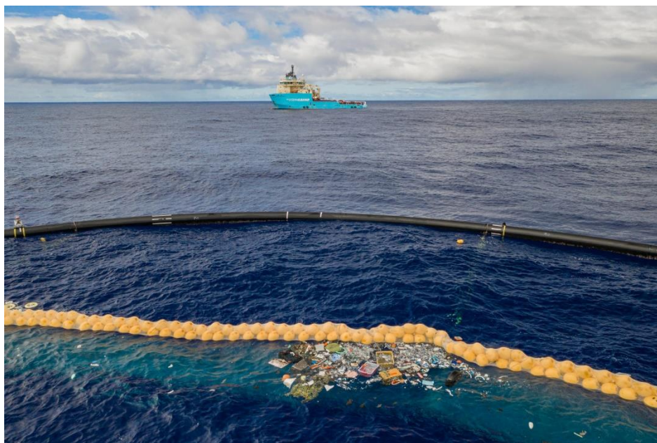
Figuur 24: Het systeem van Boyan Slat verzamelt drijvend afval aan het wateroppervlak, waarna het wordt weggevoerd door een cargoschip (©The Ocean Cleanup).
